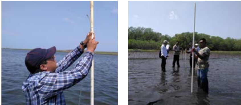
Figura 1. Medición de la microtopografía utilizando la manguera de nivel.
