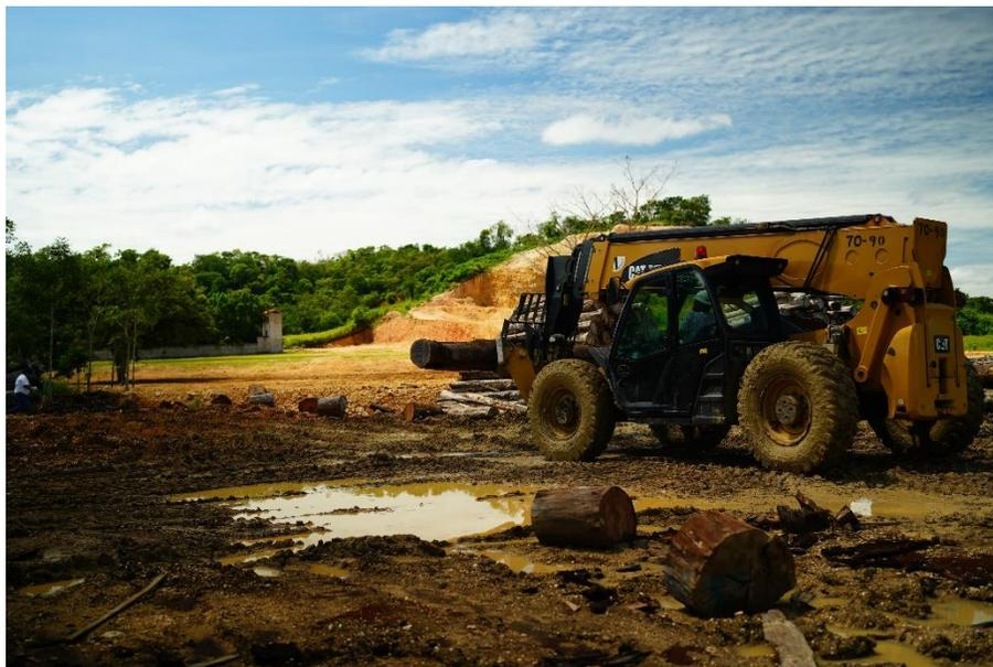
*Figura 8. Uso de maquinaria pesada para transporte de trozas para dimensionado*
